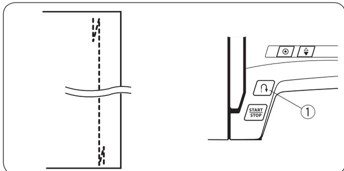
Ovom vrstom boda učvrstite početak i kraj šava povratnim ubodom. Kad dođete do kraja šava, pritisnite jednom gumb povratnog boda. Stroj će sašiti nekoliko bodova za učvršćivanje i potom će se automatski zaustaviti.
