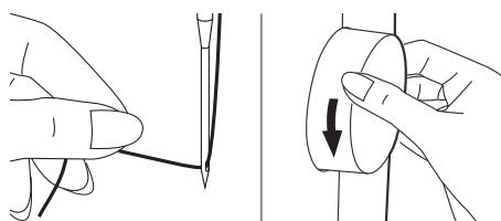
Gornji konac držite lijevom rukom. Okrenite rukom pogonski kotač prema sebi (suprotno od smjera kazaljki na satu) da spustite iglu ispod ploče za štopanje, potom je podignite da biste podigli konac špulice.
