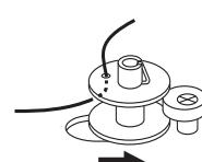
3. Navijajte konac u smjeru kazaljki na satu oko zateznih diskova.
