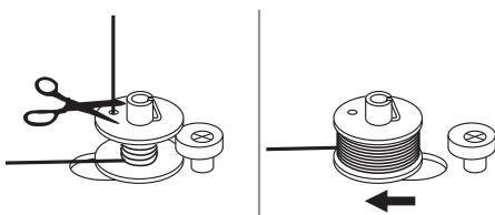
8. Nakon što se špulica namotala nekoliko puta, zaustavite stroj i presijecite konac u blizini rupe špulice. Nastavite namatati špulicu dok se ne napuni. Špulica se sporije vrti kad se napuni. Otpustite nožni upravljač da zaustavite stroj, potom gurnite sklop špulice ulijevo.
